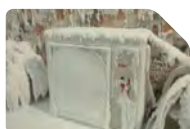
Tests de neige simulé
