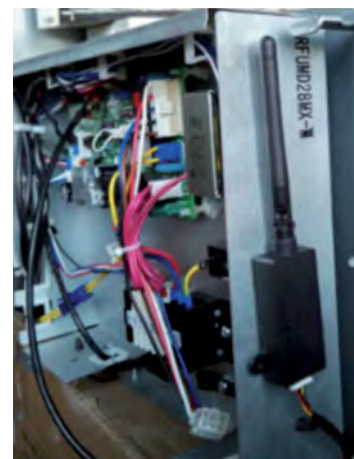
Adaptateur radio pour que l'unité intérieure soit connectée à la carte électronique respective.
