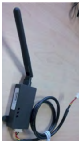
Adaptateur radio pour que l'unité intérieure soit connectée à la carte électronique respective.
