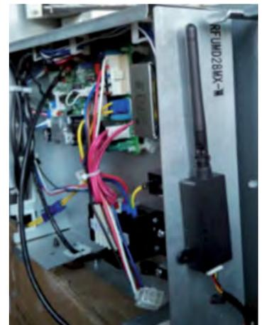
Funkadapter für die Inneneinheit, die an die jeweilige elektronische Platine angeschlossen werden soll.
